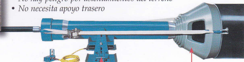
Conos de empuje y vaciado para adaptarse al diámetro de la tubería. Ahorramos vaciados intermedios.
