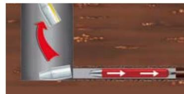
Sustituciones < DN 200 son posibles de arqueta a arqueta de 1 m de Ø. El expansor se saca en la arqueta de llegada, y la máquina, haciendo marcha atrás por dentro de la tubería nueva instalada, hasta la cala de entrada.
