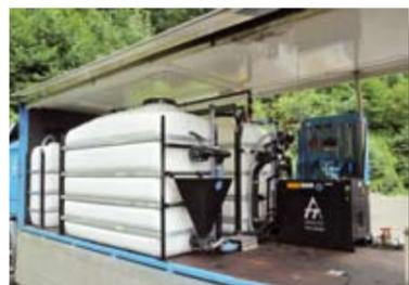
**MA 010** con bomba de alta presión: 2 tanques (4000 l c/u) rendimiento: 1200 l Bentonita/minuto; 10 kW Hatz-Diesel Motor.
