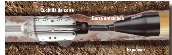
Cortar materiales no frágiles (acero, plástico, ductil)
